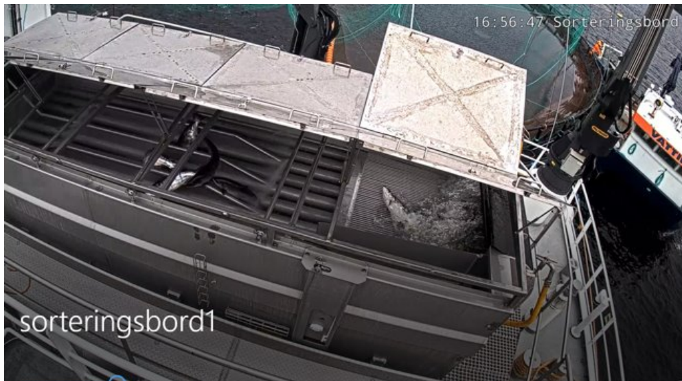
Figur 4 – Fisken passerer et sorteringsbord før den går videre til swim-in systemet. Sorteringen foregår i tre plan: (i) "Stor laks" → Rigg 3 og 4; (ii) "Små laks" → Rigg 1 og 2 (se Figur 2); (iii) Utkast (laks < 200 g, rensefisk og småsei). Foto: Napier.
