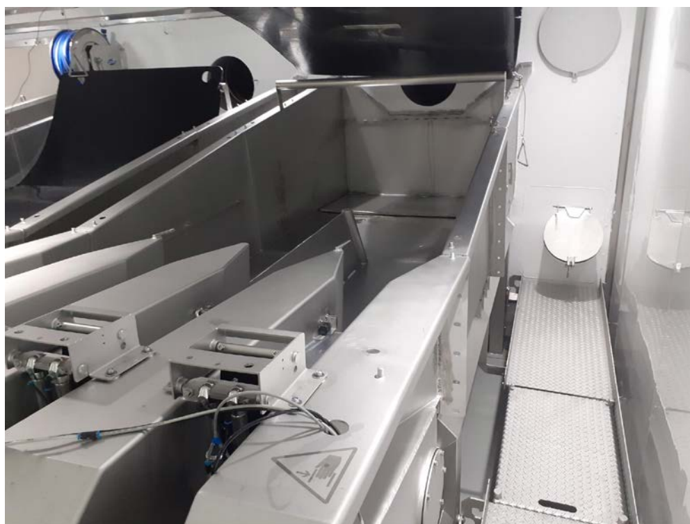
Figur 13 – Nytt innløpskar/swim-in system ble installert siden forrige evaluering av slaktelinjen. Ifølge Napier gir dette karet gir kortere oppholdstid for fisken og sørger for bedre flyt i rennen inn mot slagmaskinene. Foto: Napier.
