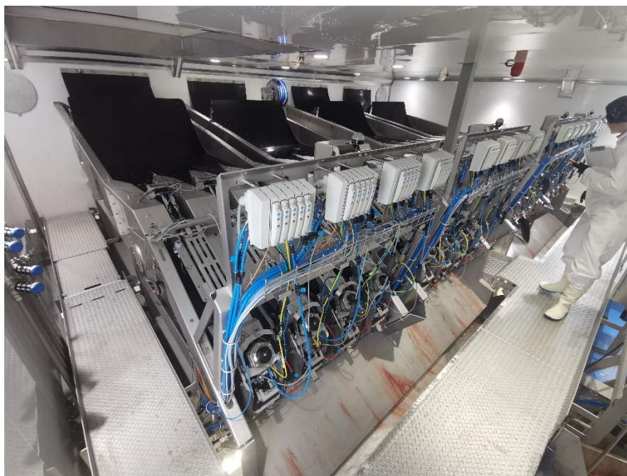
Figur 2 - Baader 101-maskiner for automatisert bedøving og bløgging av laksefisk om bord på Taupiri. Oppsettet består av 4 x 4 rigger Baader 101-maskiner ( Rigg 1: 1-2-3-4; Rigg 2: 5-6-7-8; Rigg 3: 9-10-11-12; Rigg 4: 13-14-15-16). En maskin består av 4 kanaler. I denne rapporten bruker vi imidlertid terminologien maskin 1 – 16 (M1 – M16) i stedet for kanal 1 – 16.
