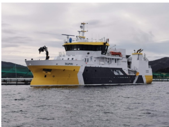
Figur 1 – Prosessbåten Taupiri slakter laksefisk på merdkanten for transport i lukket RSW-system til slakteri for videre prosessering. Fisken pumpes om bord med en av SeaQuest-pumpene (de andre brukes til lossing). Foto: Napier.
