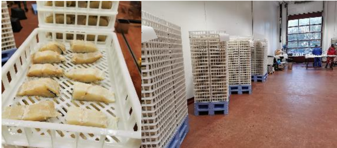
Figur 4 Lombos plassert i korgar som stables på pall før plassering i utvanningstank
