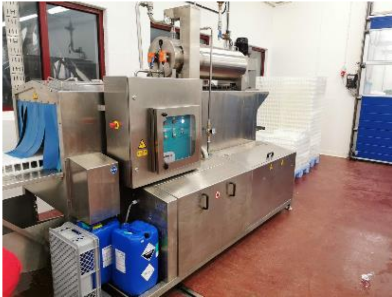
Figur 8 Kassevasker type Mimasa for automatisk vask av korgar.
