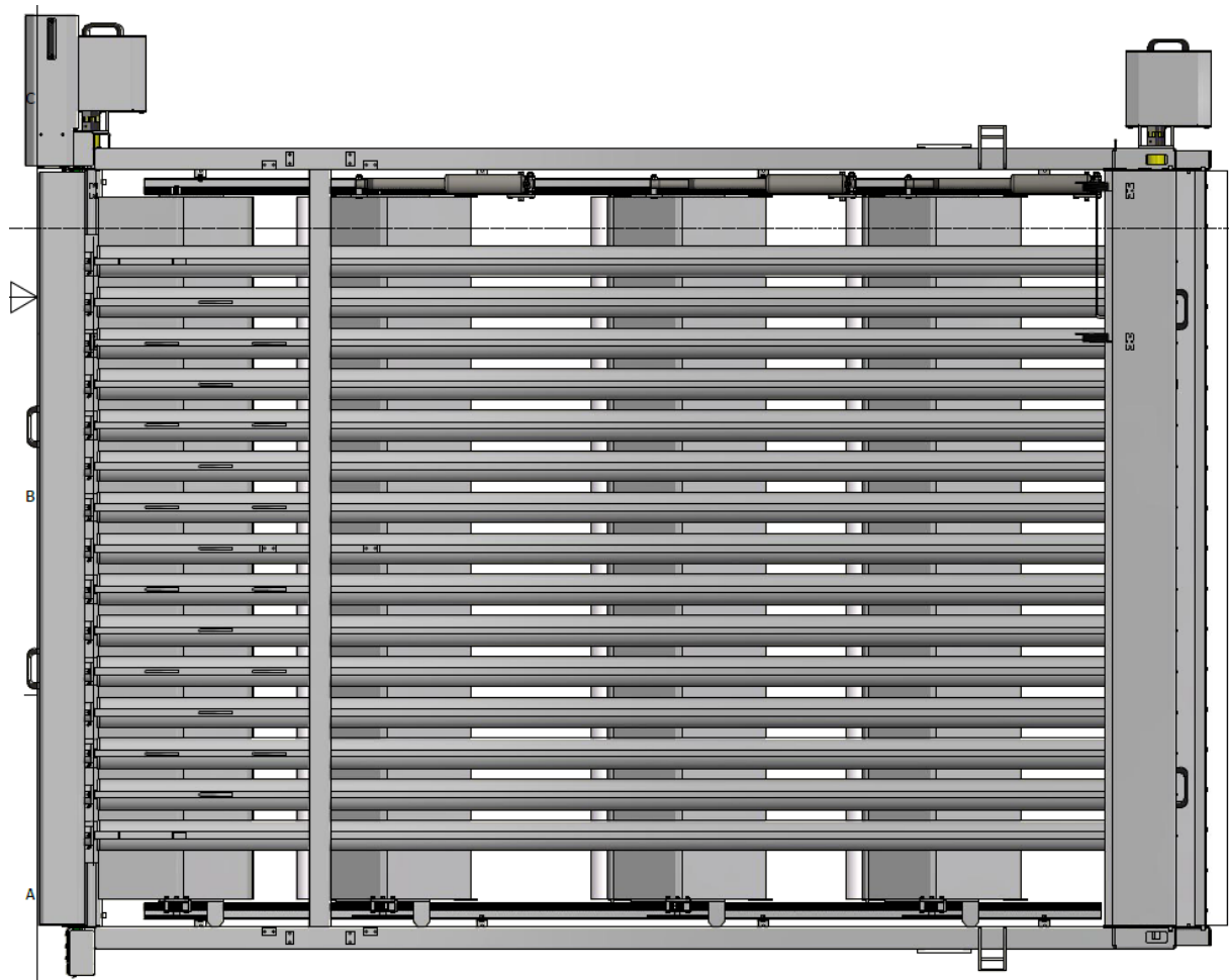
Figur 6. Rullesorteringsmaskin påmontert elektriske lineær-stempel for automatisert justering av mønetak.
