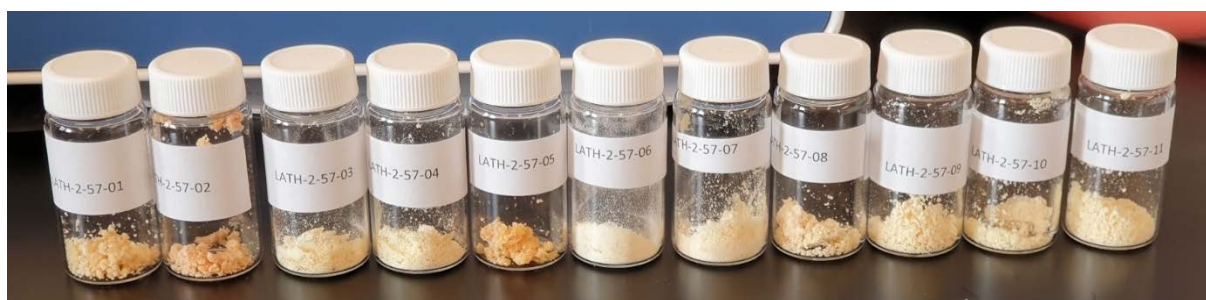
Figur 10 Bilde av frysetørkede lipidekstrakt oppnådd basert på betingelser i CCD. Nummerering av prøvene (LATH-2-57-##) angir forsøksnummer gitt i Tabell 15.
