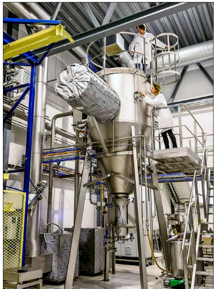
Spraytørke brukt i storskalaproduksjon av proteinpulver.
