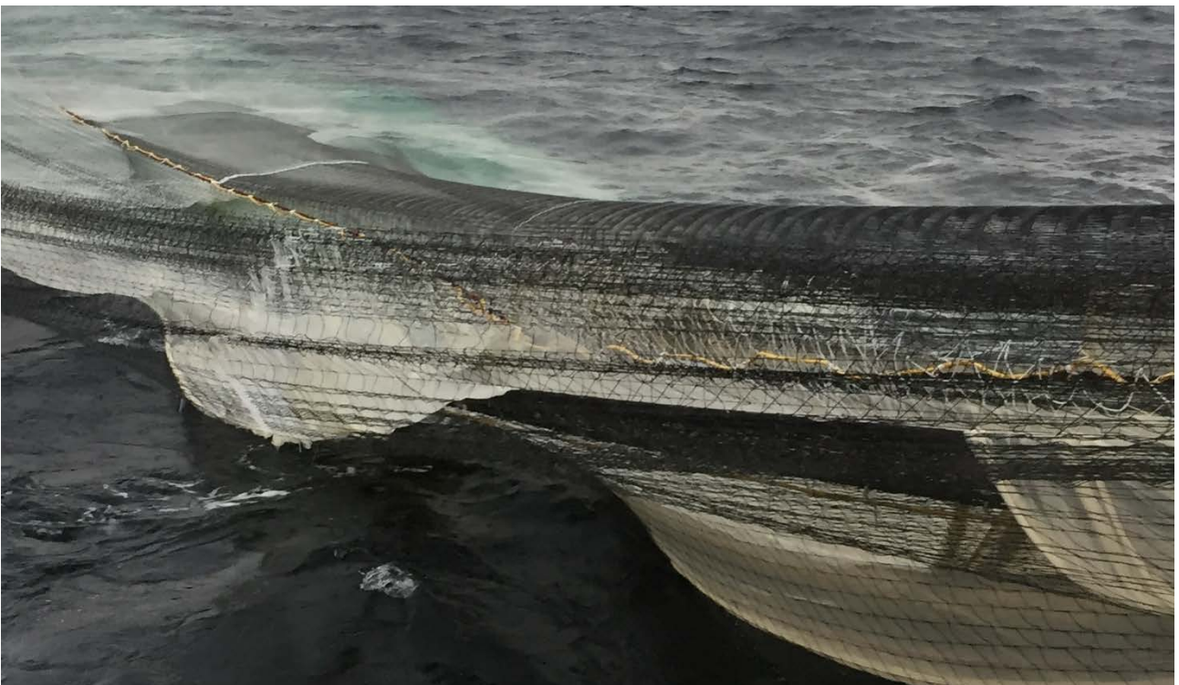
Figur 16: Bilde som viser hiving av trålen. Flere av de svarte Spectra-maskene i belgen ble revet under hiving.
