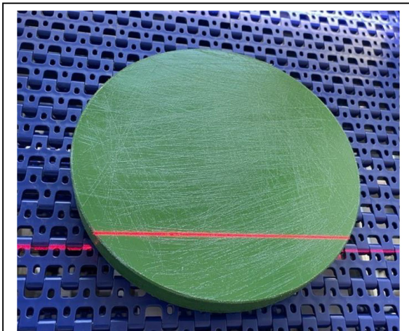
Fig 2. Sirkulært objekt for kalibrering av 3D rom
