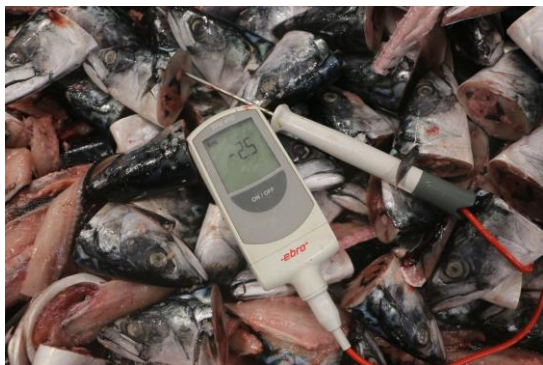
Figur 4. Temperaturmåling i restråstoffet.
