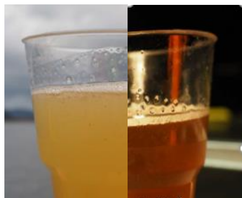
Figur 10. Ved termisk ekstraksjon ble det produsert en lys gul olje, mens det ved hydrolyse hadde oljen en mørkere brunlig farge.
