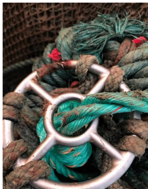
Figur 9: Slitasje på not fra kjetting i hanefot (venstre) og korrosjon i senterring (høyre).
