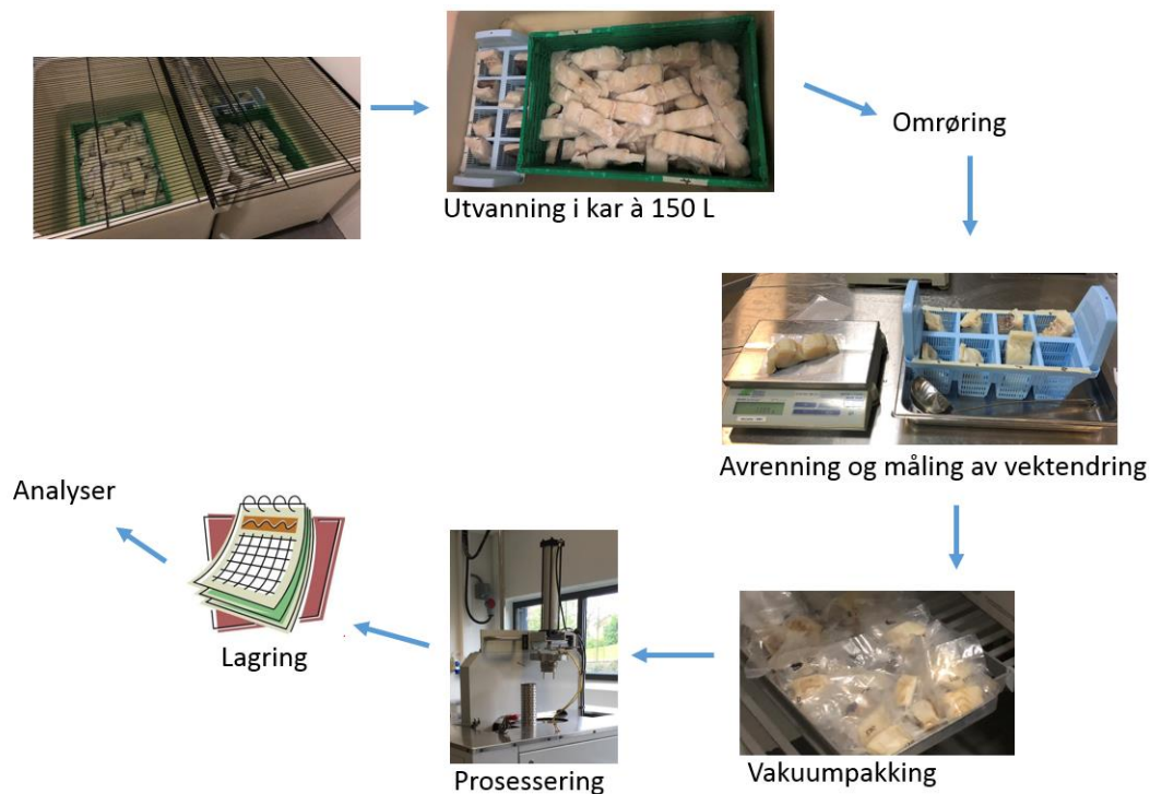
Bilde 9 Flytskjema som viser de ulike trinnene i prosessen fra utvanning, pakking, prosessering og analyse av saltfisk.
