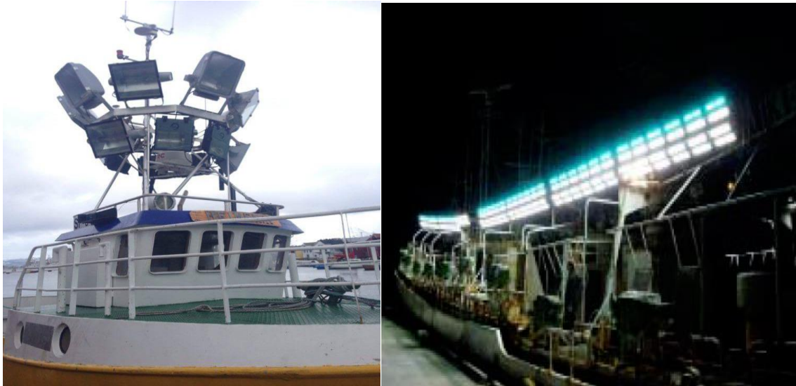
Figur 12. Venstre: Nyutrustet lysbåt med 16 stk 1000 watts gasslys. Her kreves det store diselaggregater for å produsere nok strøm. Høyre: Japansk lysbåt med LED-lys.
