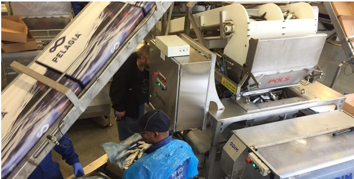
Prototypen på ensretteren står plassert under polsvekten på pakkelinje 1 i Liavågen
