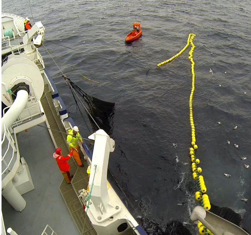
Figur 19. Geila er åpnet for å slippe ut fisk, men blir delvis stengt igjen av en not-fold som strekker seg ut fra den nederste ringen.
