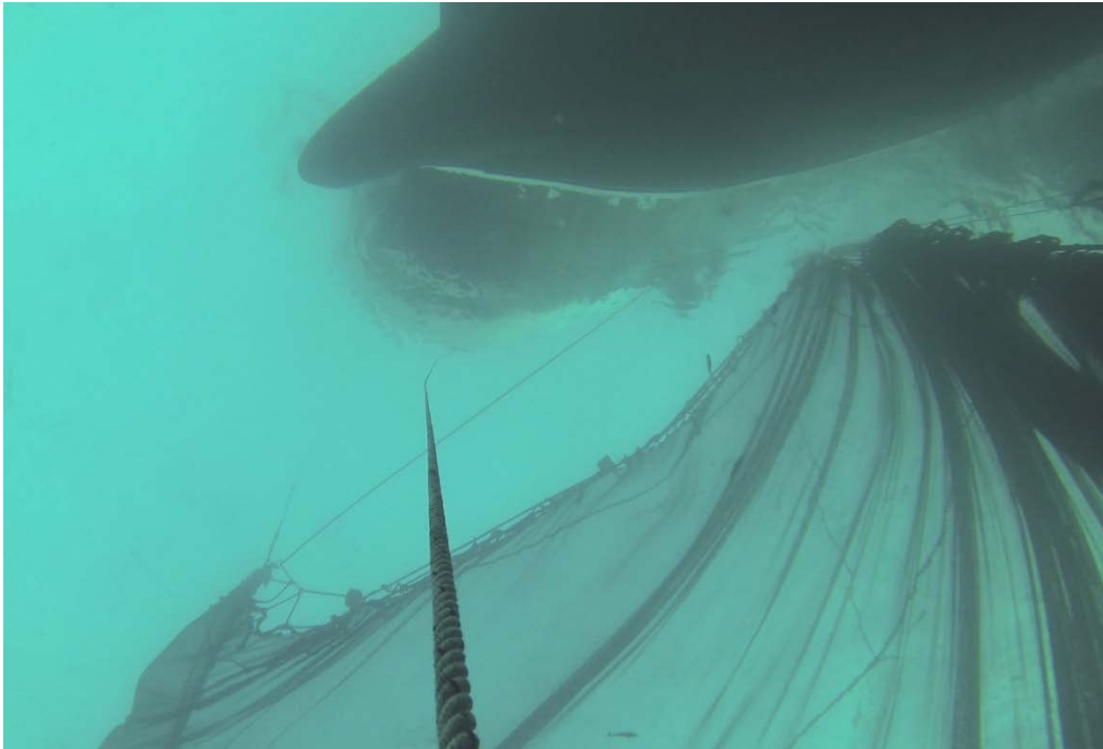
Figur 20. Åpen geil sett fra nedsenkbart kamera utenfor nota. Kamera fokuserer oppover. Øverst til høyre i bildet kan man se baugen på fartøyet. Man kan også se plasseringen av de to GoPro kameraene som var festet til geila under forsøkene.
