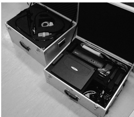
Figur 16: Mobil telemedisinsk enhet. Denne inkluderer et modem, en bærbar PC, et endoskop, utstyr for elektrokardiogram (EKG), et digitalt kamera, en skriver og en avbruddsfri strømforsyning (UPS) (Uldal et al., 2004).
