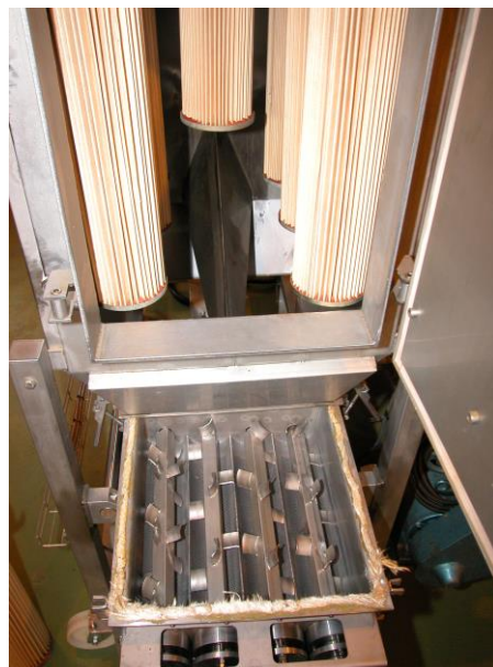
Figur 9 Mekanisk fluidisering. Multivector/Idecon-tørke installert hos Nofima, Bergen
