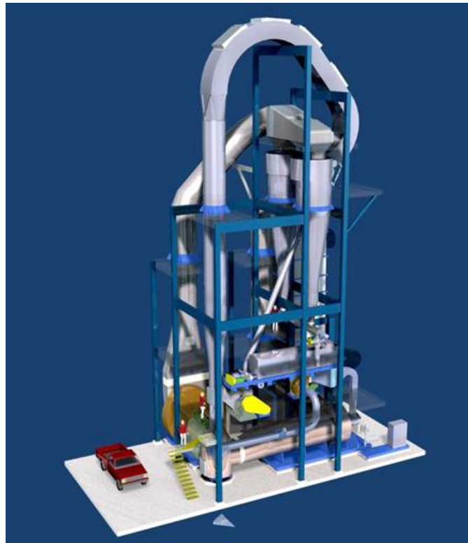
Figur 6 Eksempel på layout av en ringtørke (GEA Barr-Rosin)
