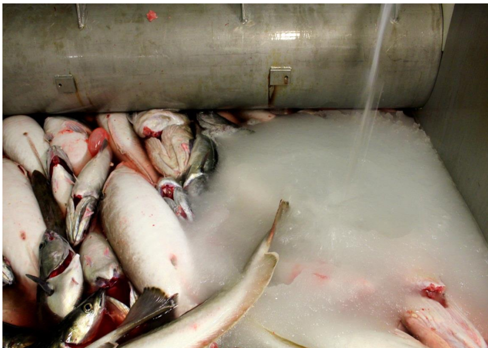
Figur 4. Islurry fylles i i ublødningkaret.
