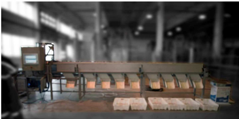
Sorteringsmaskin prototype med to spor hos Pelagia Liavåg
