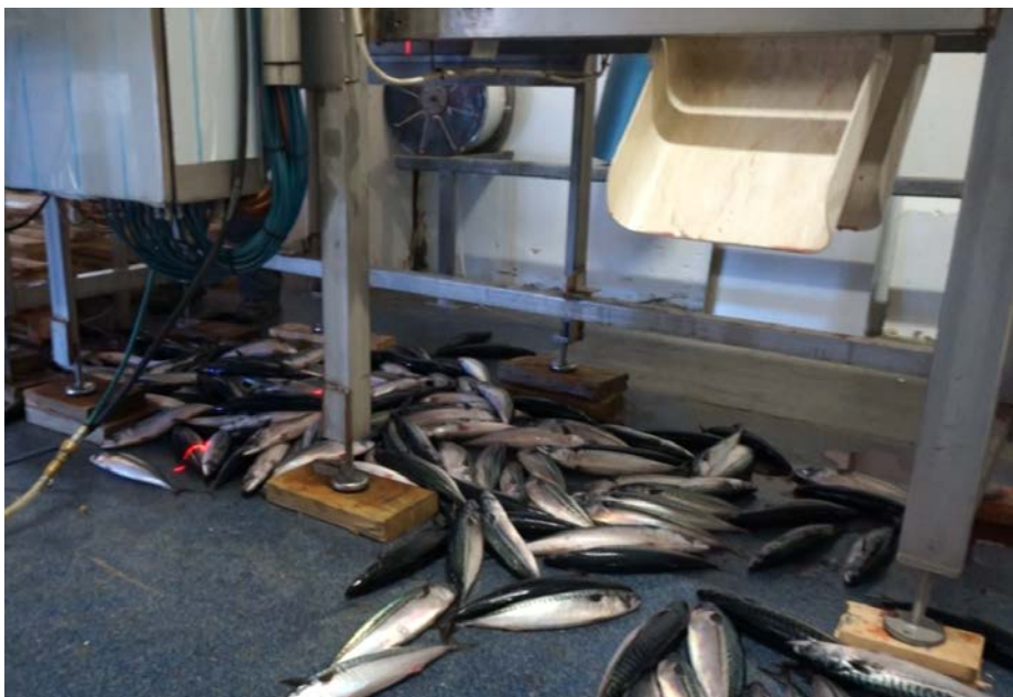
Figur 18: Fisk som ramlet av transportbåndet under kapasitetstesten.
