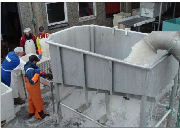
Bilde 47: Mottak ved fiskebrukene langs kysten er ofte enkle og ikke utført for å være så skånsom som mulig mot fisken. Her blir fisken pumpet på land, vanligvis sløyd fra en RSW-tank, men også levende torsk levert direkte. Skarpe kanter, strekkmetallrister og 90-graders bend påfører fisken skader som reduserer dens kvalitet og verdi.
