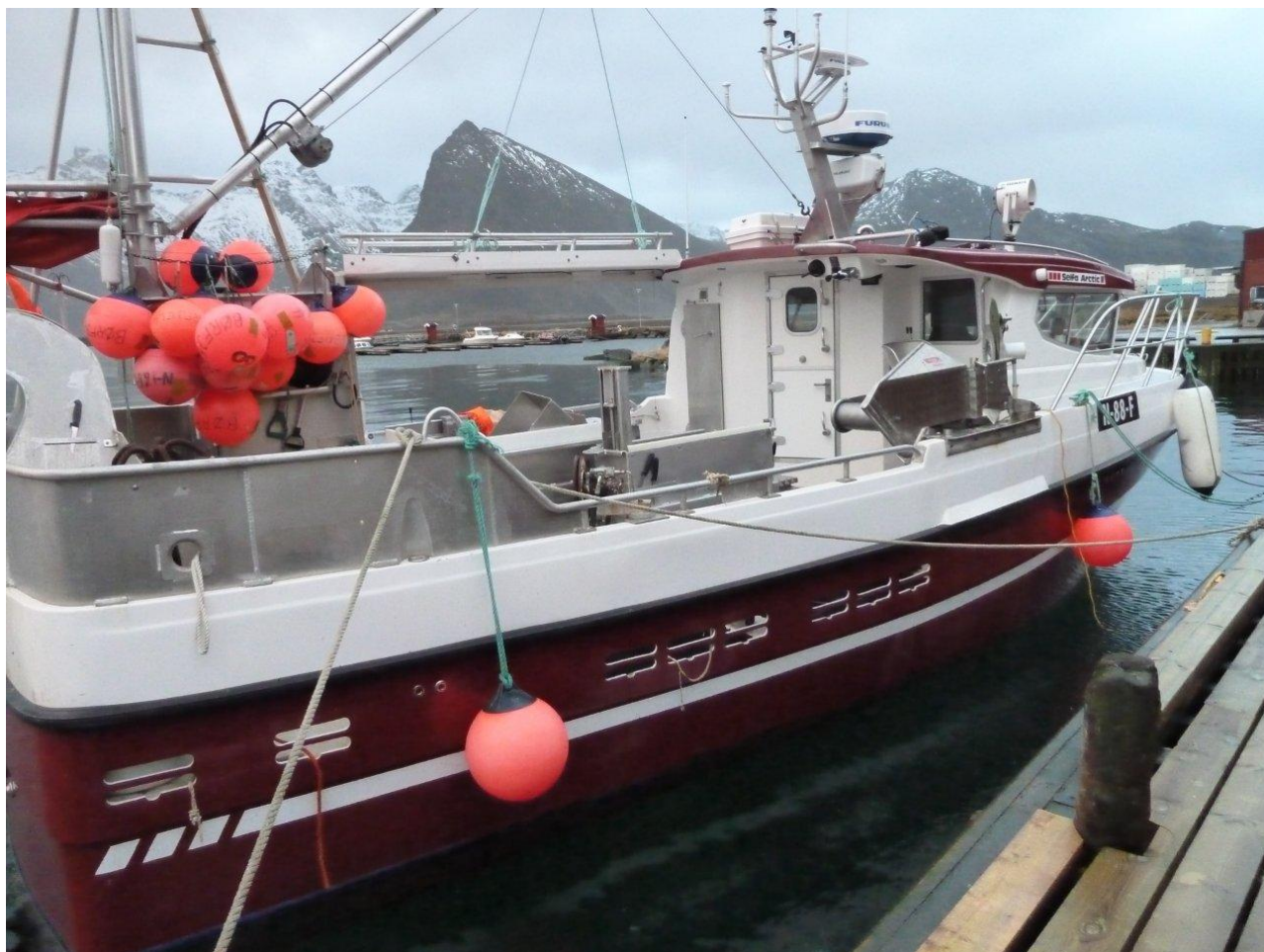
Bilde 11 Moderne Selfa 36 fots speedsjark bygget etter gjeldende krav også for lenseportareal.
