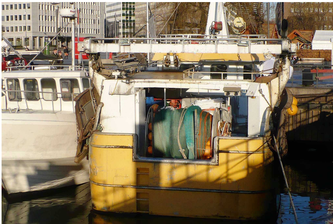
Bilde 8 Liten kystfiskebåt rigget for rekestråling i Oslofjorden.
