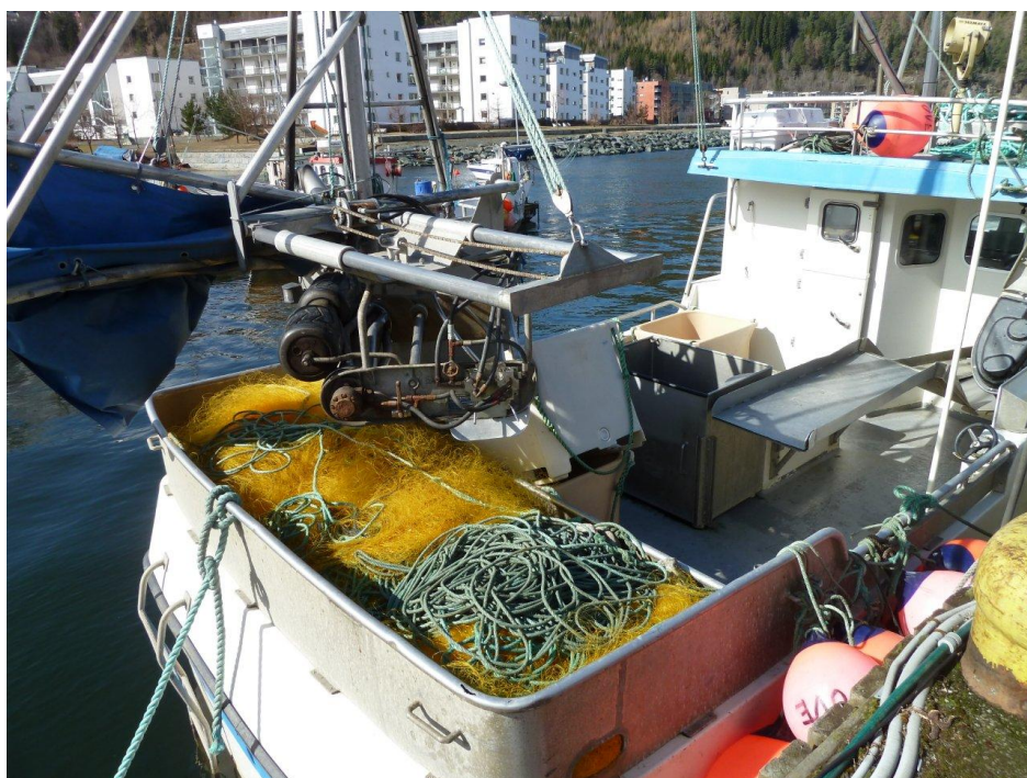
Bilde 5 Selfa kystsjarke på 34 - 35 fots lengde rigget for kyst-/fjordfiske med garn.
