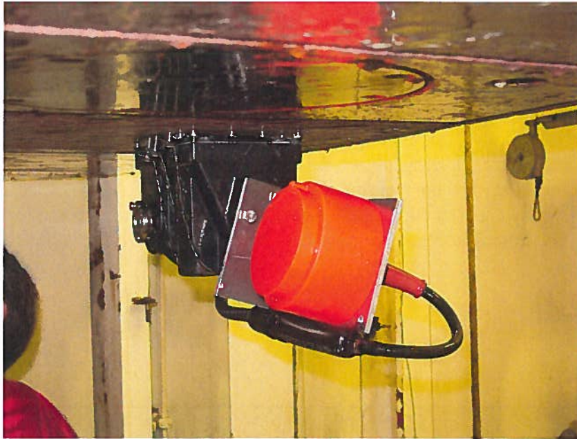
Fig.6. Tilt/pan enhet montert med ES200CD svinger på senkekjølen på G.O.Sars. Svingerkabelen med 8 ledere + skjerm er også kuttet og skjøtet med full undervannskjøt. Rotasjonen av svingeren er begrenset fra +15 til -90 grader.
