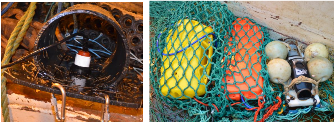
Figur 1. Venstre figur viser Simrad ES10 svinger montert i en ramme bak i forlengelsen av trålen. Høyre figur viser HUB (gul), sonar (rød) og Furuno trålløye montert på senter kuletelne.
