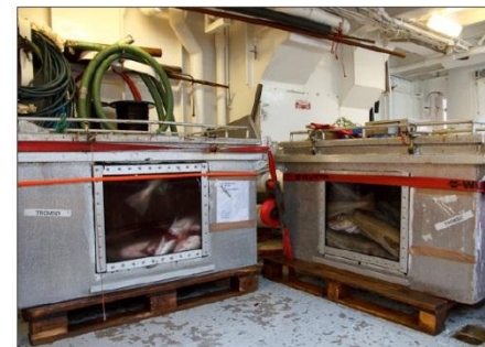
Bilde 8-9: Fra forsøk med levende fisk fra trål; mer enn 90 % overlever selv om fisken hales opp på tråldrekket først.
