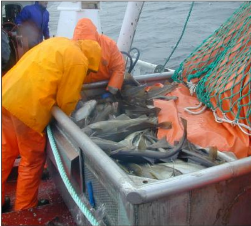
Bilde 29: Mottaksbinge for torsk. Bingen er kun 40 cm høy, og utstyrt med vanntilførsel fra bunn. Torsk sorteres og sendes ned i føringsrom via en fleksibel slange. (se også bilde 1)
