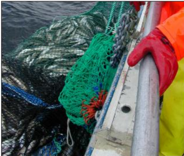
Bilde 24: Kjettingvekt krøkes fast i sekkeløftet 3–4 masker foran codlina. Under utsetting trekkes løft med kjettingvekt til side og slippes ved siden av snurrevadsekken for å hindre vase.
