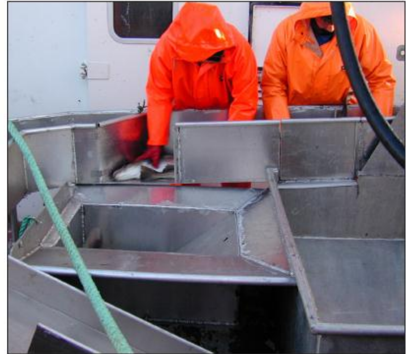
Bilde 30: Fisken slippes fra ordinær mottaksbinge ned i rennesystem hvor den sorteres og deretter slippes ned føringsrom.
