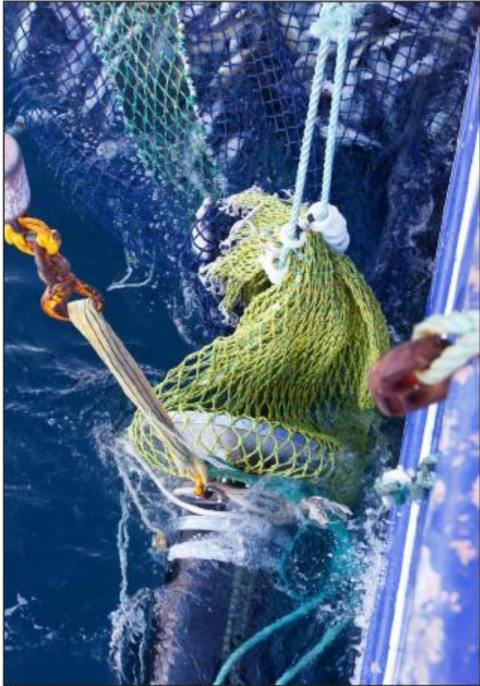
Bilde 27–28: Slangen fra under-/overtrykkspumpen blir festet direkte til snurrevadens cod-end og lagt langs fartøyets styrbord side. Skipperen tørker sekken på Triplex slik at fisken strømmer uten hindringer om bord.
