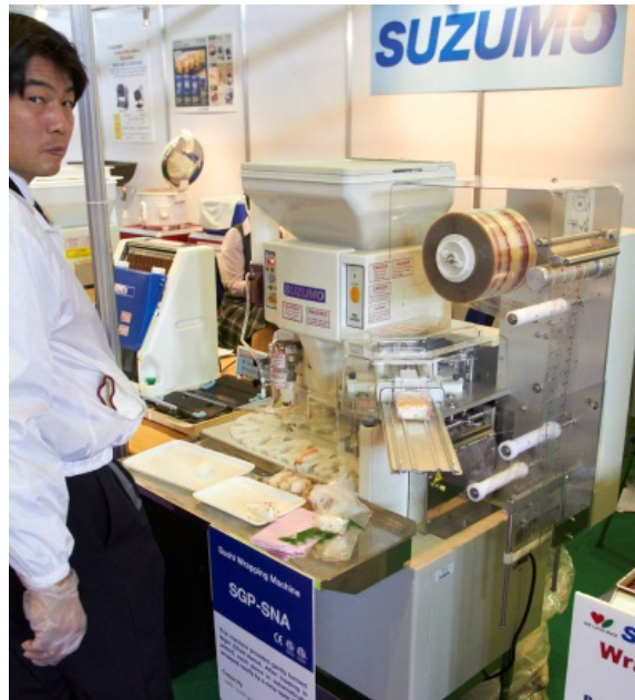
Bilde 22 Maskin som lager risputer og pakker hver enkelt bit i folie
