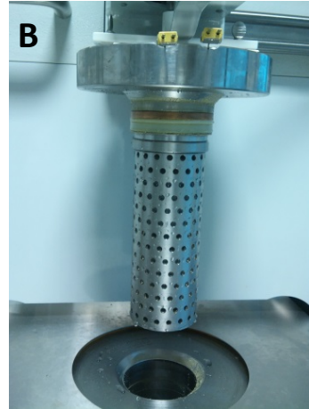
Figur 2 Utstyr for høytrykksprosessering (A) med nærbilde av kammer for plassering av produkter for høytrykksprosessering (B).Kammeret er på ca 2 L.
