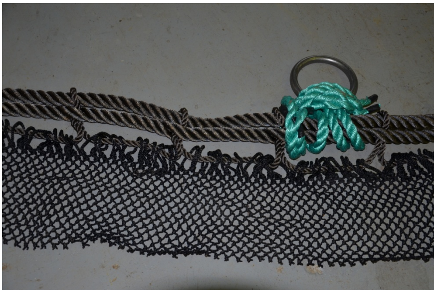
Bilde 3. "Skjørt" med garnering, telner og ringer for ny flåsnurpe.
