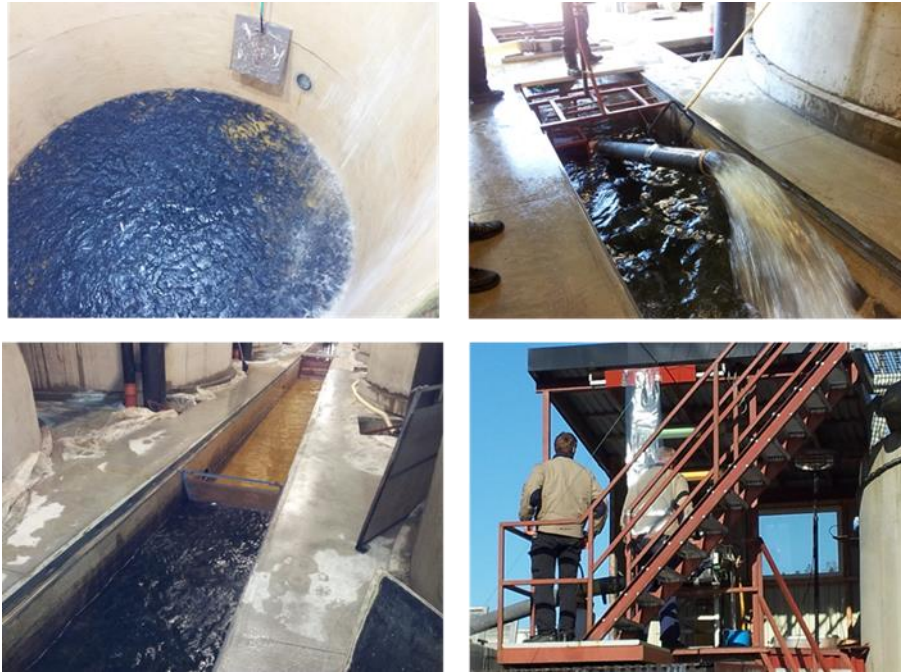
Figur 43 Prosess. Trenging av fisk ved å senke vannet (øverst til venstre). Legg merke til «kuøyet»; når vannet var ca. 10-15 cm under dette startet utfasingen av fisk. Fisken blir skjøvet nedover med skyveskott i raceway (nederst til venstre, øverst til høyre). Fisken blir pumpet opp til tellemaskin nå vei ut til bil (nederst til høyre)
