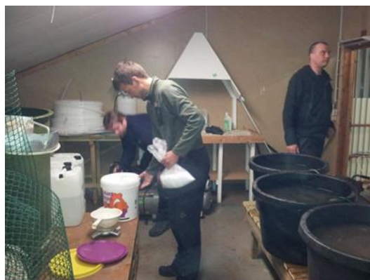
Figur 45 Preparering av saltvann og bøtter til saltvannstesten.
