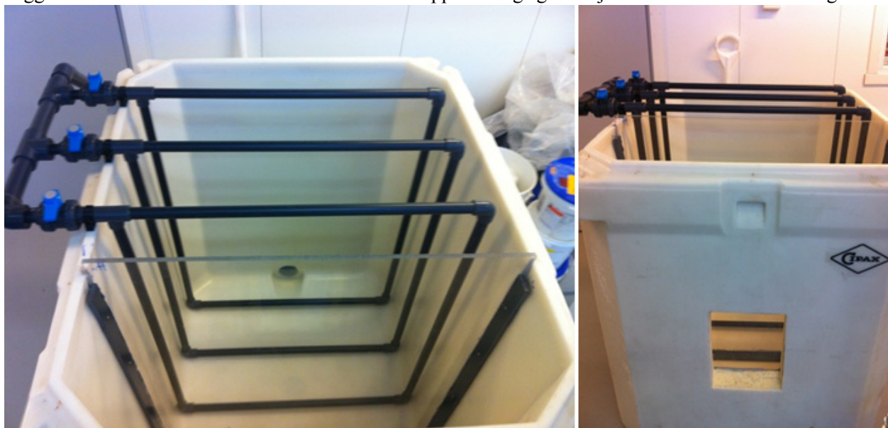
Figur 2: Tankarrangement med skillevegg og rørinnsats (SINTEF, 2011)
