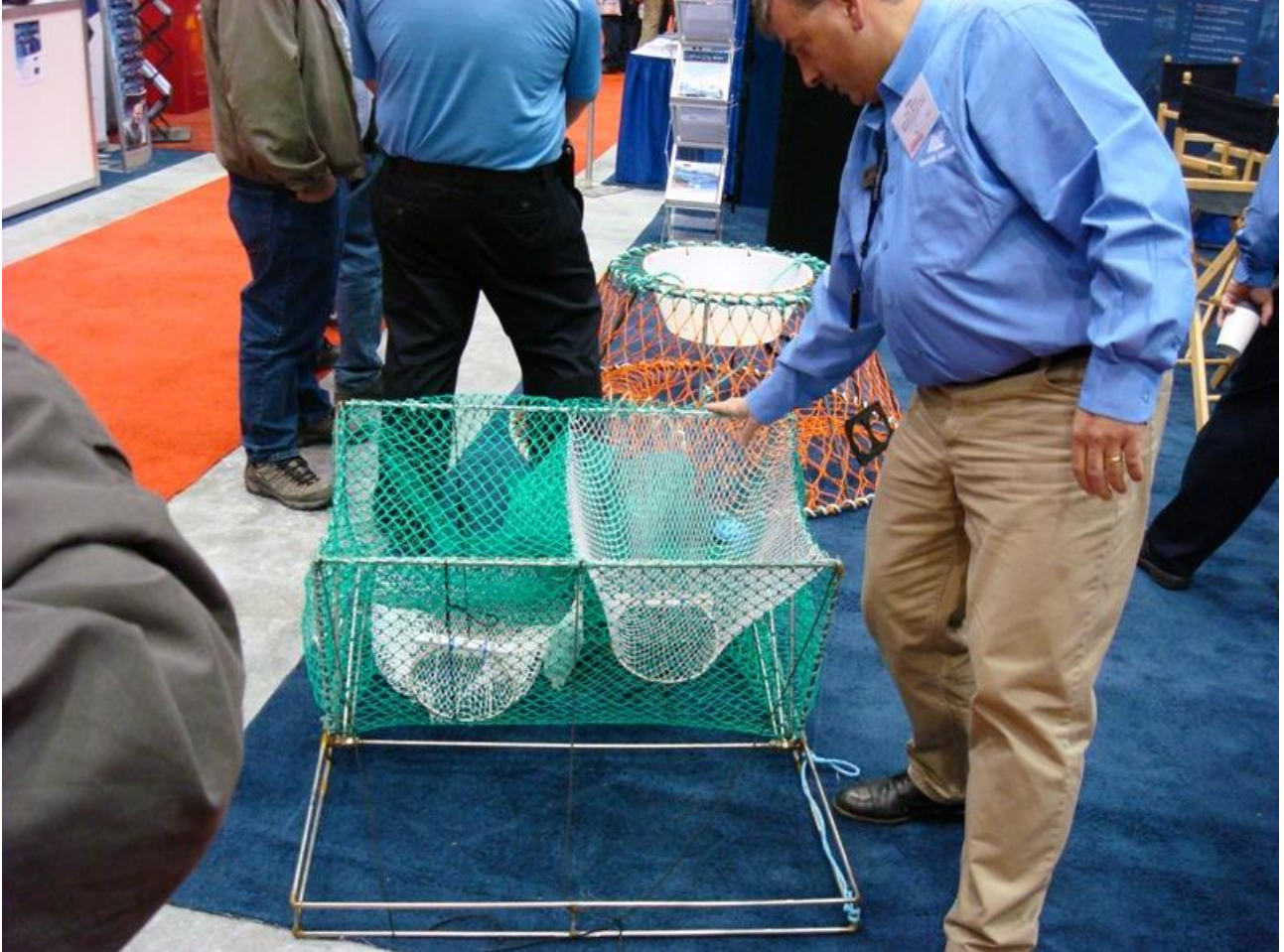
Bilde 3 Den canadiske teinen er sammenleggbar. Her demonstrerer Phil Walsh prinsippet på en nedskalert (1:2) modell (Foto: Lasse Rindahl).
