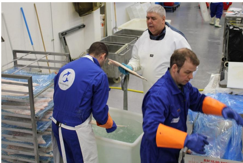
Figur 2.2. Glasering og pakking av lettsaltede fileter før innfrysing ved -30^{\circ}\text{C} .
