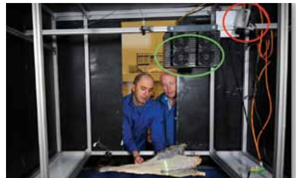
Slik ble maskinsynet gjennomført med 2D og 3D kamera i kombinasjon med laser.
