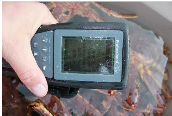
Bilde 10 Viser håndholdt elektronisk oksygenmåler brukt under transport av kongekrabbe.
