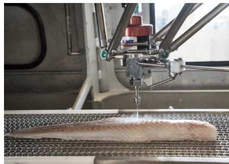
AUTOMATISERT: Her er den automatiserte fillettskjæreren som skal sørge for et stort framskritt på trålere, først på «Ramoens».
