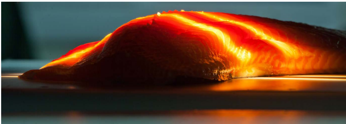
Figur 4 Laksefilet med projiserte lyslinjer som viser interaktansoppsettet. Spektrografen registrerer hvor mye lys som kommer ut av fileten midt mellom lysstripene.
