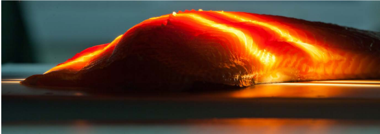
Figur 1 Laksefilet med projiserte lyslinjer som viser interaksjonsoppsettet. Spektrografen registrerer hvor mye lys som kommer ut av fileten midt mellom lysstripene.
