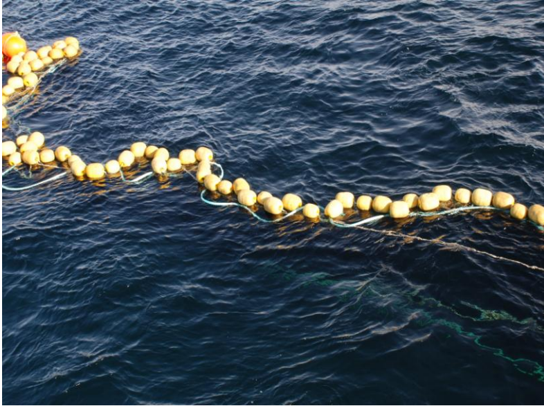
Figur 7. ”Jolletau” (hvitt) har kastet seg inn og ut over flåen under setting. Friksjon mellom tau og flå forhindrer enhver form for bevegelse av tau relativt til flåtelna.
