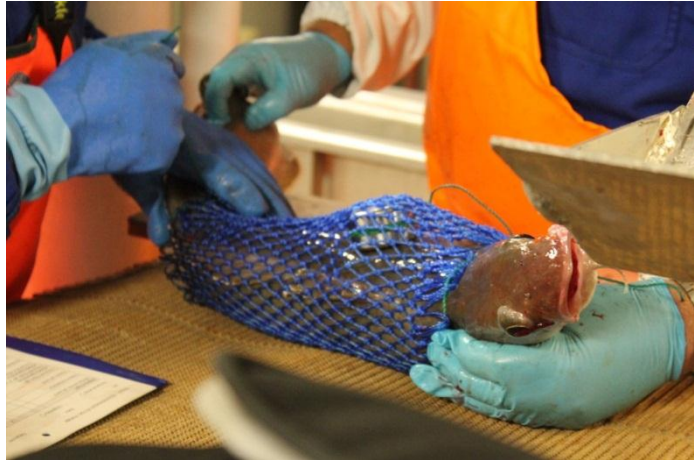
Måling av temperatur i enkeltfisk.
