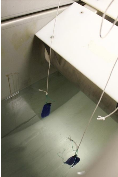
Temperaturlogg i utblødingstank 2.
