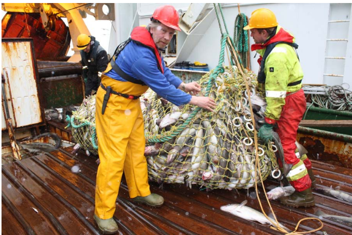
Bilde 23: Sekken en fangst på med ca. 3 tonn Torsk. Roger B. Larsen viser overrasket den tynne PE tråden som holdte mye mer enn 3 tonn fisk i sekken før den røk.
