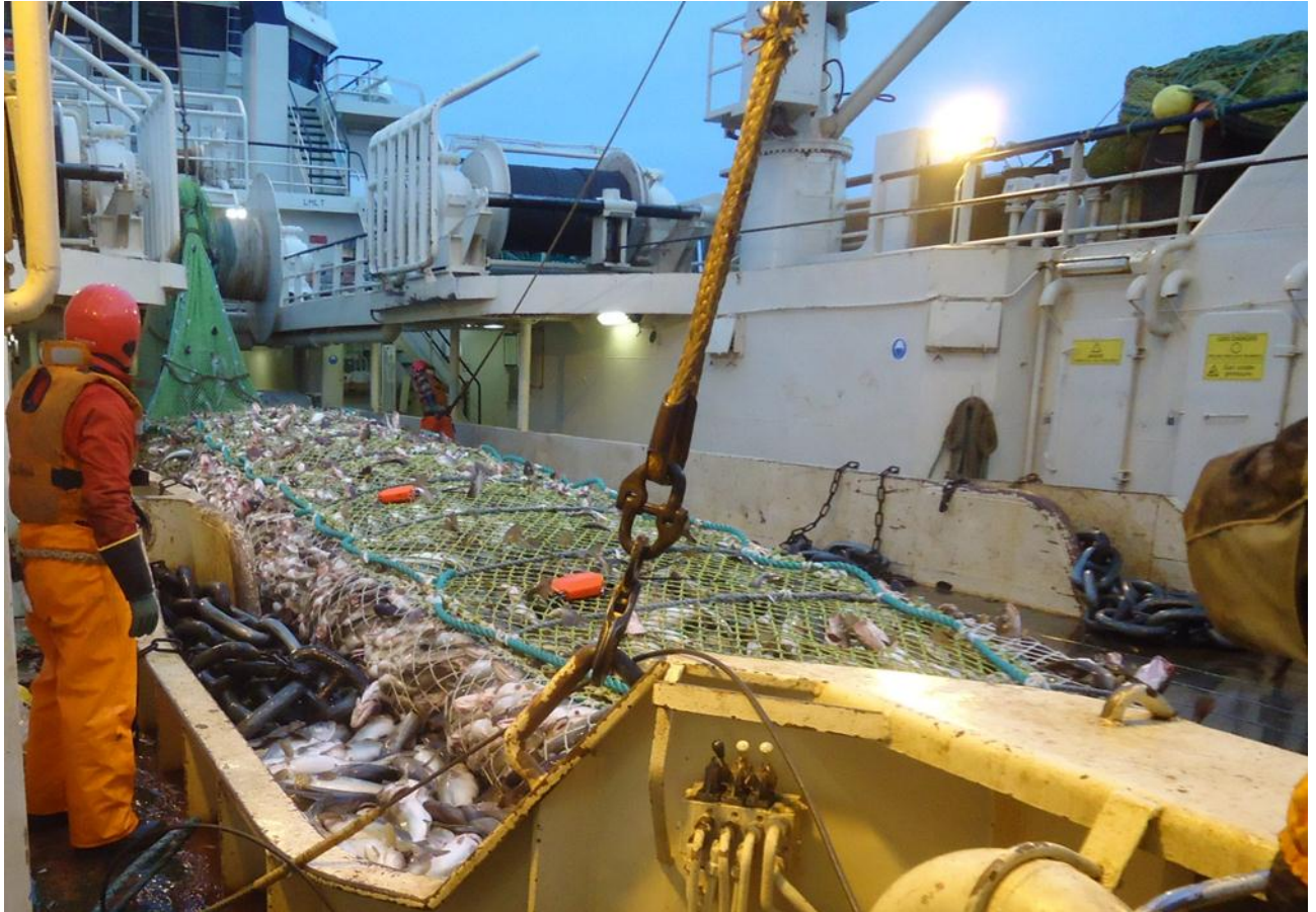
Fangst på 34 tonn tatt med pelagisktrål ombord MT Ramoen i oktober 2012. Sekken har to side paneler laget av 130mm Exit Window for å garantere seleksjon av småfisk. (Bilde: Ivan Tatone, Universitetet i Tromsø)
