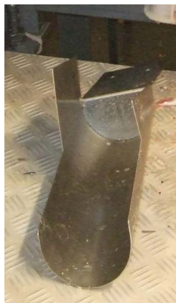
Figur 16: Detalj fra Baader fileteringsmaskin for sild som viser bukkniver, og hvor rogn faller ned fra maskinen. Noe rogn følger bukkappen ned rett etter bukkniver, og noe rogn faller ned ved rensehjul. Mage, tarm og melke følger sammen med rogn (fra Østvik, et al.).
