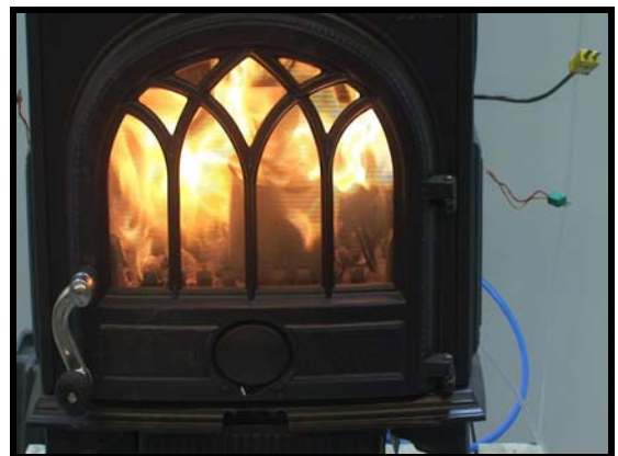
Fig 11. Utbrenning m regulert lufttilførsel
