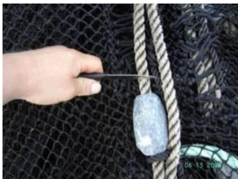
Figur 5 Renskjæring av bly
