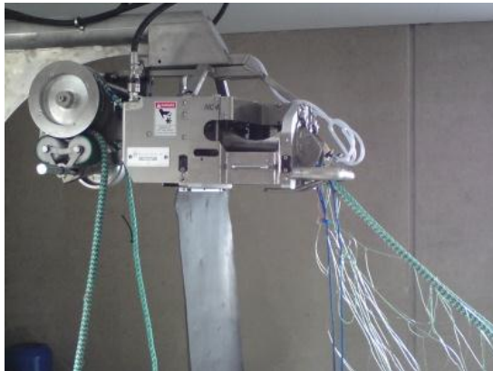
Figur 15 NetCutter 4 renskjærer garnlinet fra tauene
