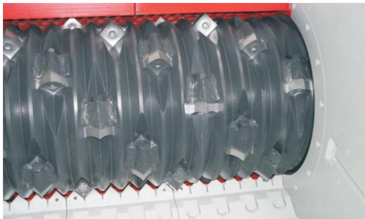
Figur 20 Innmaten (skjæret) i en Vecoplan shredder
