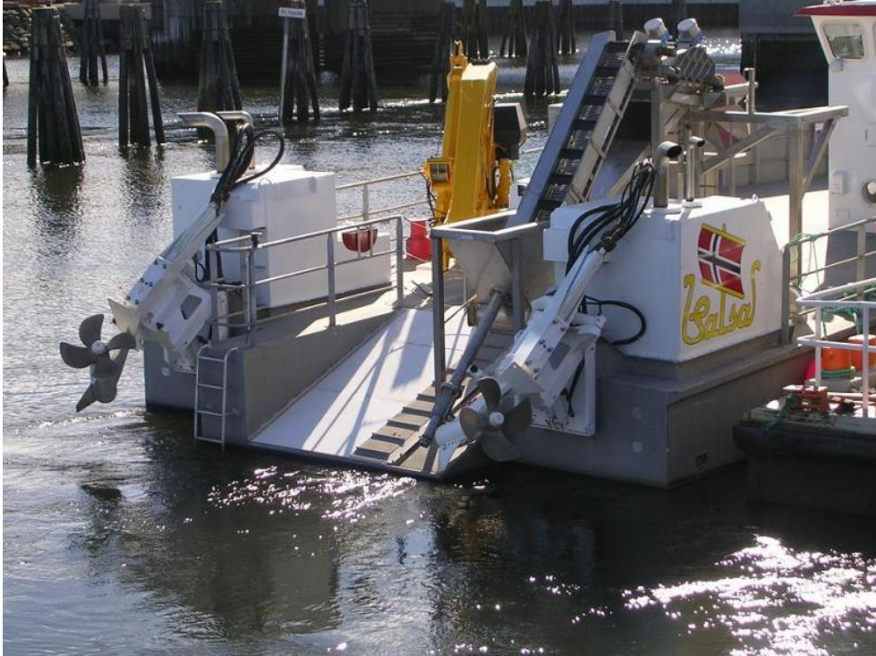
Figur 4: Salsa produkter A/S sin Båt som brukes til mekanisk hjerteskjell høsting i dag.
