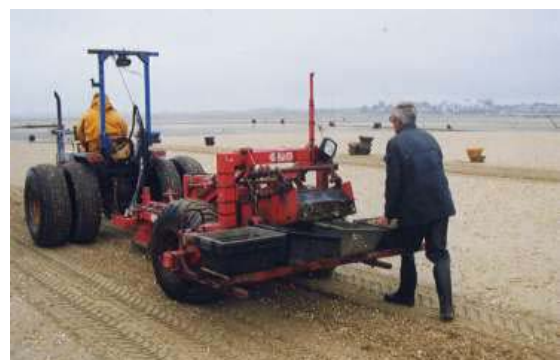
Figur 4.2.2: Traktorraking etter hjerteskjell på en fransk strand (Ifremer)
