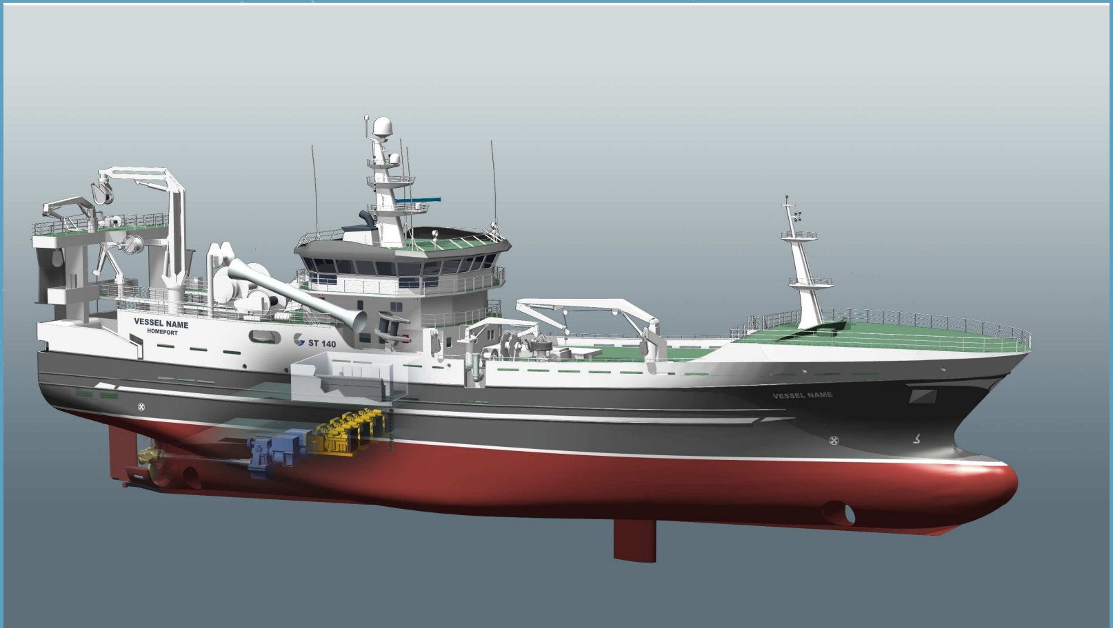
ST-140, Dieselelektrisk fremdrift i neste generasjon ringnot?
