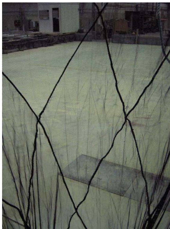
Figur 15: Not 5 uten sidetau i hjørnene. Notlinet og nota deformeres kraftig. Et notlinfelt, som i utgangspunktet er kvadratisk, får en markant avlang fasong.
