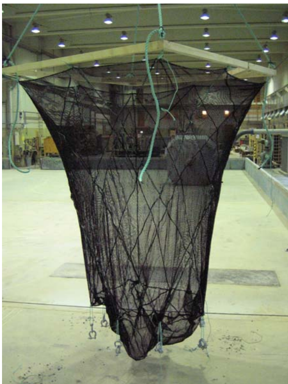
Figur 4-4: Not med skrå tau uten sidetau i hjørnene, loddsett i stille vann. Modellnota tilsvarer 24 meter dyp not mens den numeriske modellen er av ei 12 meter dyp not.
