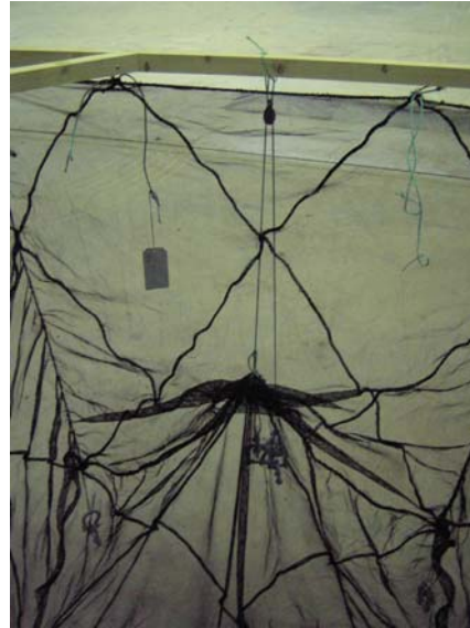
Figur 12: Not 4. Venstre: Poser i bunnen. Høyre: Heving via sidetau.
