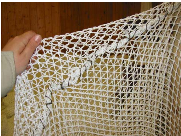
Bilde 1: Sammenføring av notlin foregår for hånd. Ved flaggorienterte masker, vil notlinsømmen ha en vinkel på 45 grader i forhold til sidetauene.
