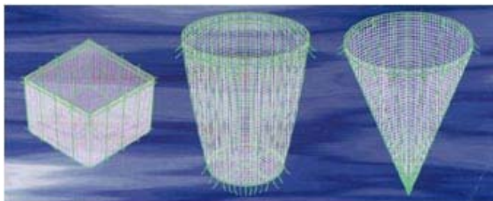
Bilde 1: Prinsipper for oppdrettsnot benyttet i lakseproduksjon (Figur hentet fra Egersund Net AS). Fra venstre: Firkantnot, sirkelnot og kjeglenot.
