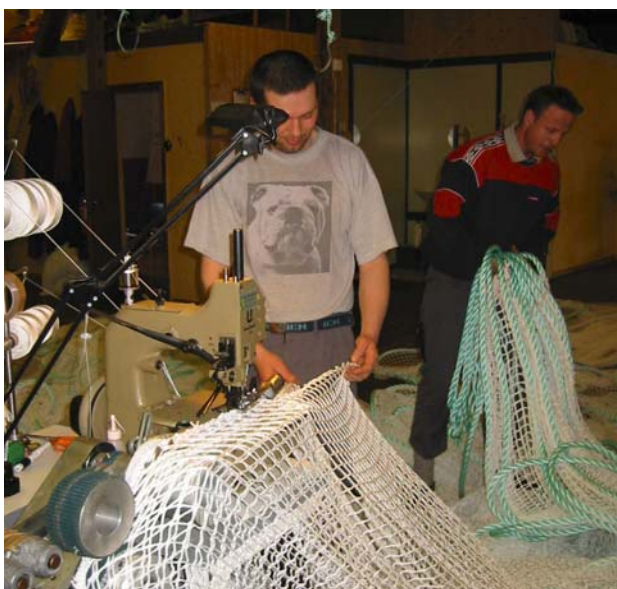
Bilde 2: Side og bunn blir sydd sammen med maskin. Alle tau festes til nota med maskinsøm.
