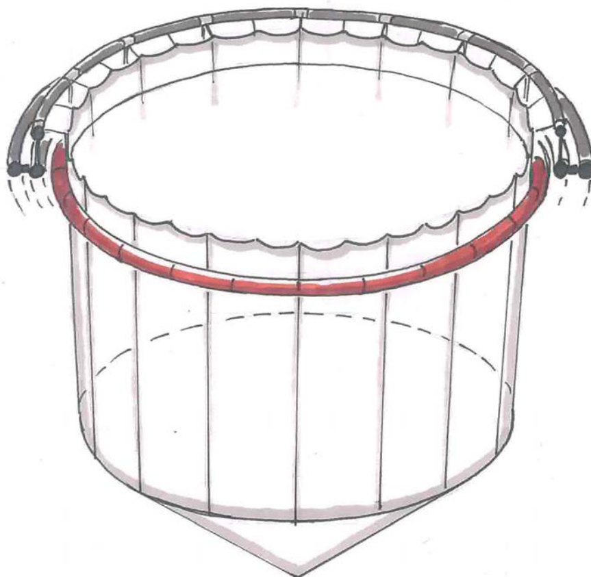
Figur 10. Notpose med integrert oppdrift.
