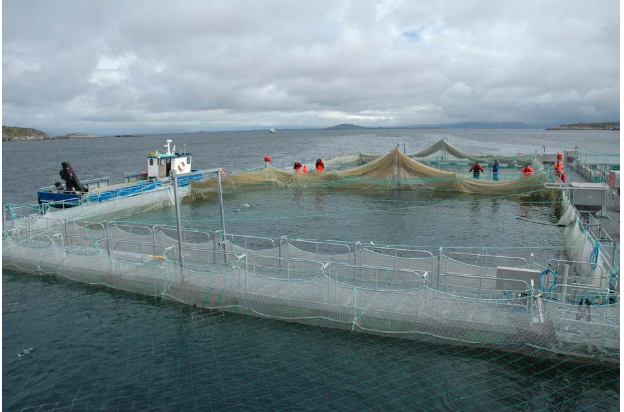
Skifte av not ved hjelp av eget serviceteam (Foto: Gustav-Erik Blaalid)
