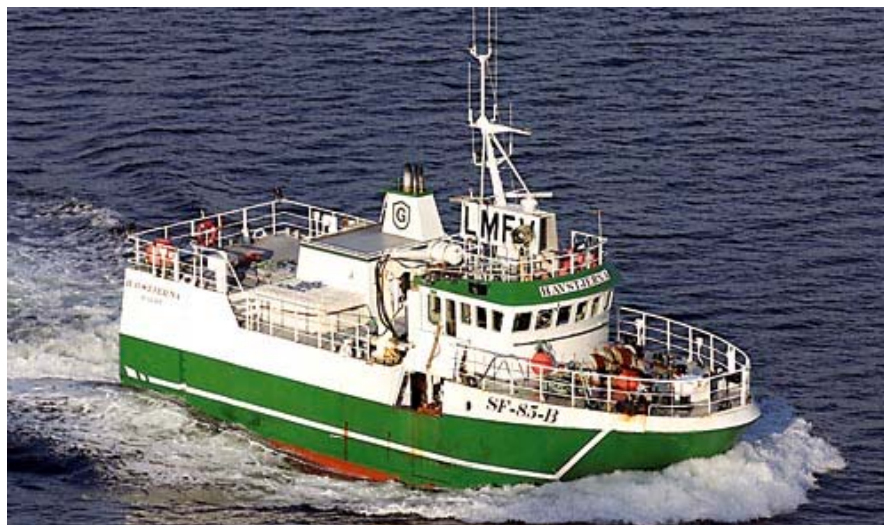
Bilde 1: Det kombinerte line- og garnfartøyet M/S "Havstjerna". Lengde 21,0 m, bredde 6,4 m og dybde 5,4 m.
